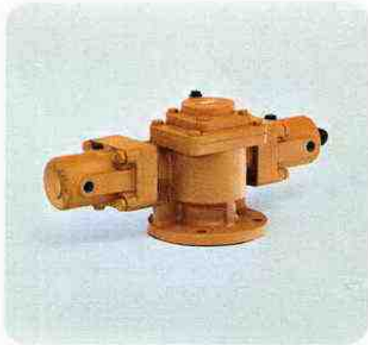
Качающий привод; крутящий момент до 2650 данм, давление до 200 бар более подробные сведения смотри RD 09 118
